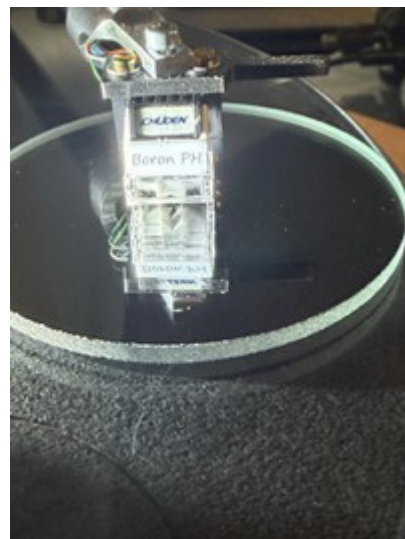
FIG 1: A cápsula pousada sobre um espelho de “primeira superfície” com 2 mm de espessura
