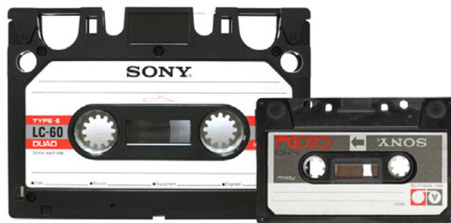
Comparação do ELCASET com cassete normal
