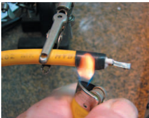
Figura T-03: Aplicando calor para contrair o tubo termo-contrátil.
