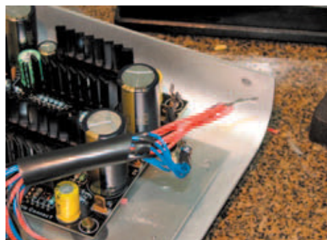
Figura T-02: Os cabos a serem soldados estão em contato firme e direto antes de aplicar a solda.
