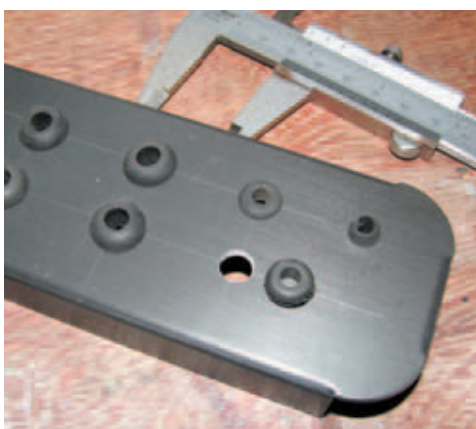
Figura T-06: Perfurações alinhadas e arruelas das medidas para cada cabo. A última está sem fixar ainda.
