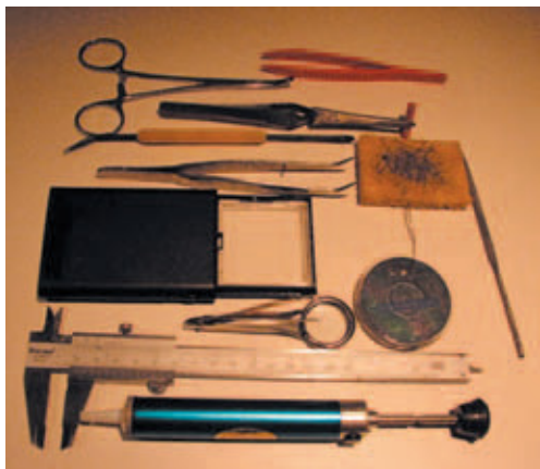
Figura F-03: Vemos uma pinça de plástico, uma Kelly curva, uma auto-fechante para dissipar calor, uma escova de aço, uma lima delicada para eliminar restos de solda, uma esponja, uma anatômica curva, uma lupa com luz, uma pinça com lupa, solda de prata, calibre e sugador de solda.
