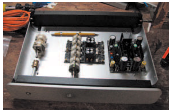
Figura 7: Alguns dos componentes da DACT. À esquerda, chave seletora CT-3-5-8, montagem em ângulo reto, extensão do eixo e acoplamento CT-Ext1; no centro, atenuador CT2-6 deck montado sobre um par de CT101; à direita, módulo de fonte de alimentação CT102. O conjunto apresentado sobre a base de um chassis CT-Encl1.
