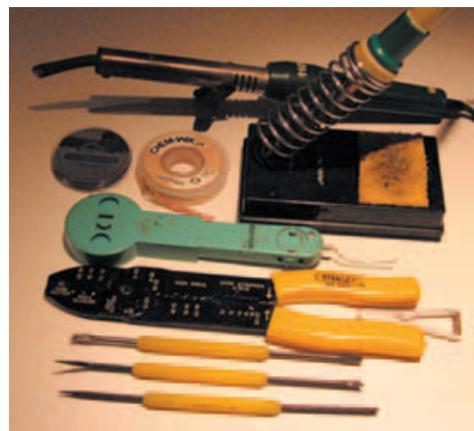
Figura F-02: Vemos soldador de 250 W e de 60 W no seu suporte que inclui esponja, solda de prata e cobre sugador, suporte para estanho, pinça pelo-cabos, pinça limitadora de aquecimento e três acessórios para completar a solda (tirar impurezas, gotas de estanho, etc.).
