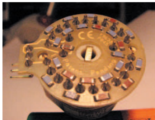
Figura 4: Vemos os resistores tipo SMD (em azul) na base do atenuador DACT.
