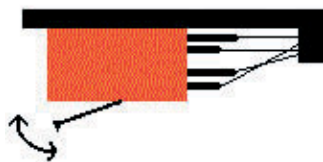
Figura 22: Ângulo de oscilação do cantilever. Quando aplicado um peso à agulha, o cantilever irá se posicionar num ponto do arco descrito, determinando o VTA. Como pode ver, o peso influirá no VTA em forma direta.
