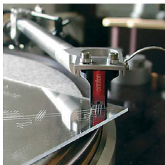
Figura 11: Um dos gabaritos Wally em uso. Este gabarito é feito específico para cada marca e modelo de braço. Observe a base espelhada.
