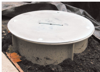
Fig 01-b: ...e com a tampa colocada. Todas as varetas estão conectadas entre si e com uma caixa de conexões dentro do laboratório.
