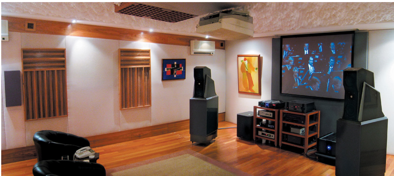
Parede frontal com o novo painel de difusores e novas áreas de absorção
