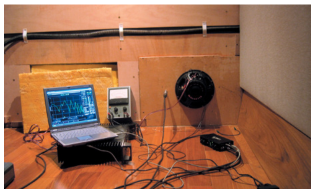
Sintonizando o absorvedor de 24 Hz
